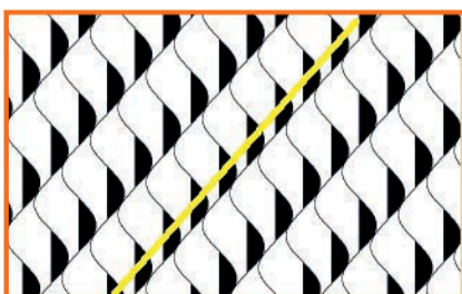
Частота – 30 Гц Сдвиг = – 10 мсек/трассу Наклон волны – вправо
